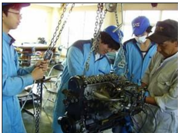
自動車のエンジンの分解整備や車検整備の実習。
